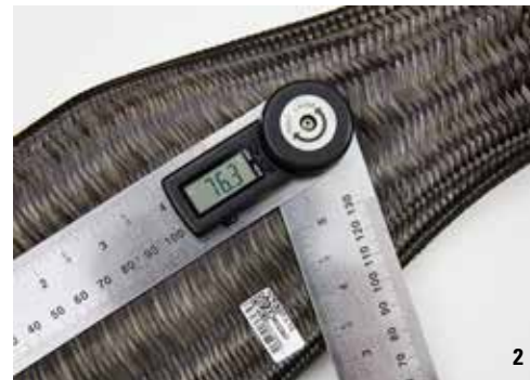
1 De carbonframebuizen worden ontwikkeld op basis van een geautomatiseerde weeftechnologie
